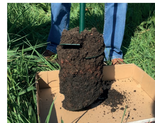
Prélèvement d'un échantillon de sol sur le site du Pré-verger de Bugnicourt
