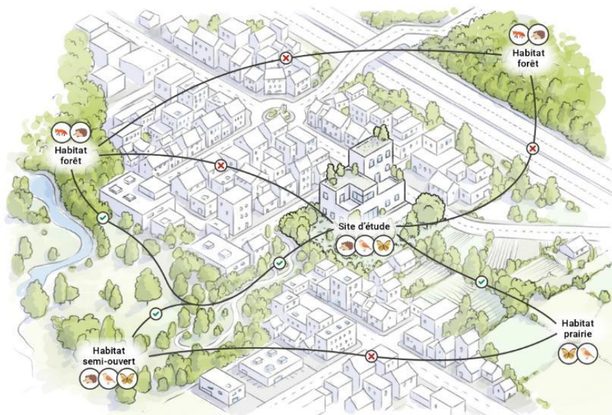
Figure 5 : Principe du calcul de connectivité autour d'un site donné
